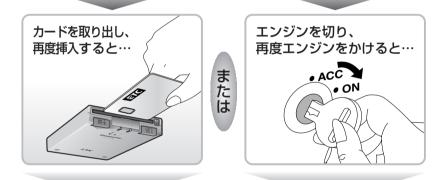
スタンバイインジケータが点灯し、 「ポーン ETCカードを確認しました」と案内されます。 エラーが解除され、復帰したように見えますが、 料金所で開閉バーは開きません。
