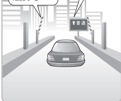
**7** ETC車載器と路側アンテナの間で、料金の精算に必要な情報が通信されます。
