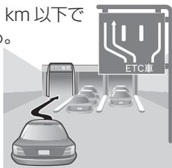
**3** ETC車載器と路側アンテナの間で、通過するために必要な情報が通信されます。
