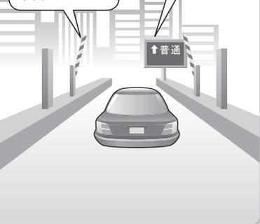
**7** ETC車載器と路側アンテナの間で、料金の精算に必要な情報が通信されます。
