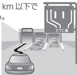
**3** ETC車載器と路側アンテナの間で、通過するために必要な情報が通信されます。
