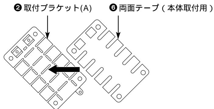
**2** 本体ユニットの取付位置を決め、取付ブラケット(A)を取付位置の形状に合わせて変形させる。
