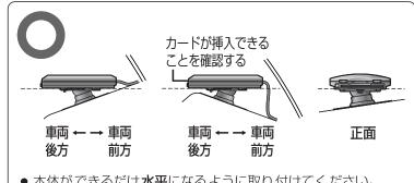
◆本体ができるだけ水平になるように取り付けてください。[許容範囲:0°~20°(車両前後方向)]
