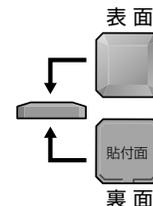
ダッシュボードの傾きに応じて、角度調整台座を使い分けてください。
