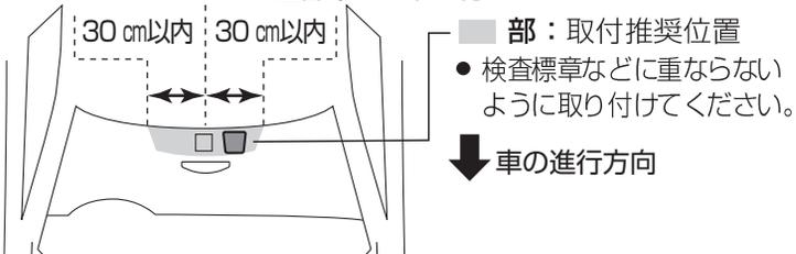
水平面を基準にして、 $20^{\circ} \sim 50^{\circ}$ の範囲に取り付けてください。
