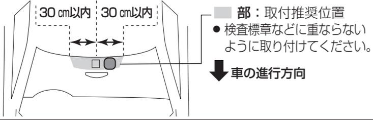
水平面を基準にして、 $20^{\circ}$  ~  $50^{\circ}$  の範囲に取り付けてください。
