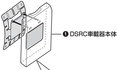
取付ブラケットのツメに、DSRC車載器本体の取付穴をはめ込む。
