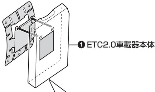
取付ブラケットのツメに、ETC2.0車載器本体の取付穴をはめ込む。
