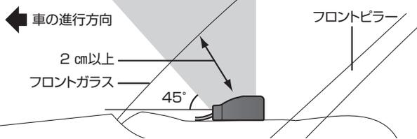
●アンテナの上側45°よりも上の位置(■部)に障害物がないように取り付けてください。
