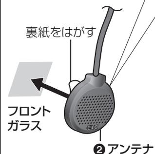
アンテナコードが落ちないように、線材固定テープをコードに巻き付け、ルーライニングとガラス面の隙間に入れ込む。
