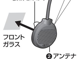
アンテナコードが落ちないように、線材固定テープをコードに巻き付け、ルーライニングとガラス面の隙間に入れ込む。
