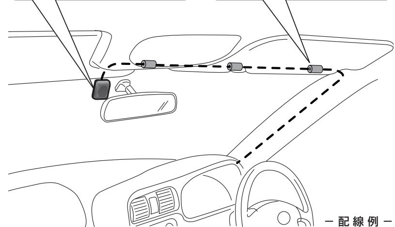
コードが落ちないように、線材固定テープをコードに巻き付け、ルーフライニングとガラス面の隙間に入れ込む。
