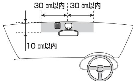
水平面を基準にして、 $20^{\circ}$ ～ $60^{\circ}$ の範囲に取り付けてください。
