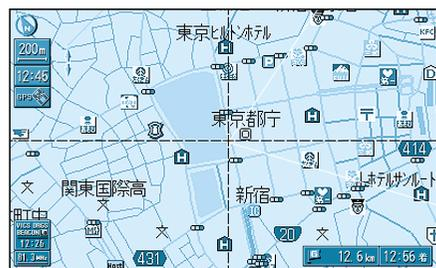
現在地画面以外では画面の中心を始点にして、目的地の方向と自転車の方向を2本の直線で表示します。
