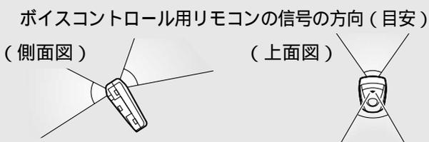
ボイスコントロール用リモコンをハンドルに取り付ける場合、必ずテレビモニターのリモコン受光部の受光範囲内に取り付けてください。
