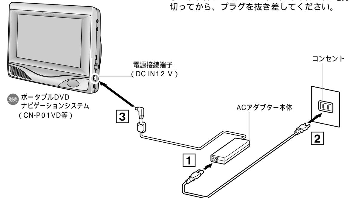
接続のしかた : ① ② ③の順(出力電圧の高い方から接続する)
