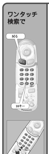
リモコンのカバーを開け、10キーを押すと ダイレクトに各検索画面を呼び出せます。
