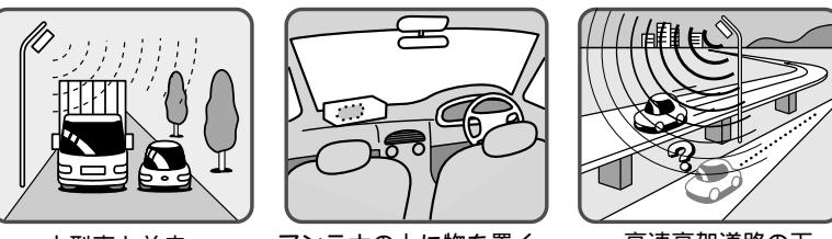
高速高架下の一般道を走行している場合に、高速道路の電波ピーコンを受信してしまう場合があります。
