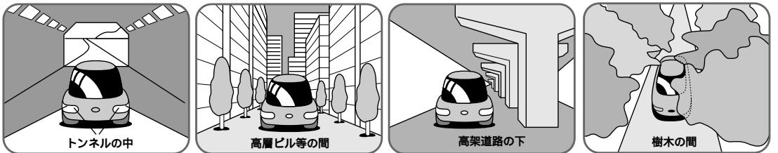
ルーフキャリアなど使用時には、GPSアンテナとルーフキャリアを離して設置してください。GPS衛星は、アメリカの国防総省により管理されており、故意に位置精度を落とすことがあります。このようなときは、自車マークがずれることができます。
