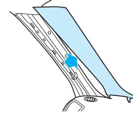
② アンテナコードの給電部を、アンテナに貼り付ける。
