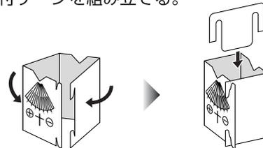
② 車体が水平になる場所で、取付ゲージの⊕側をナビゲーション本体の前面に図のようにあて、本体の取付角度を測る。
