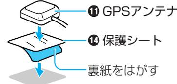
※ルーフキャリアの近く、またはトランクリッドなどに取り付けると、GPS衛星からの電波を受信しにくくなります。
