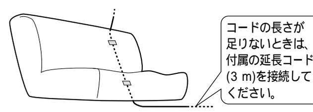
**お願い** 電源コードやGPSアンテナのコードとは、できるだけ離してください。シートレールやドアなどに挟み込んで、コードを破損しないようにしてください。
