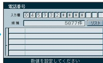
電話番号の入力は、ジョイスティックの上下で数字が変わり、左右でカーソルが移動します。10キーでも入力できます。
