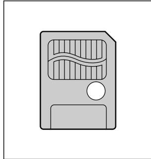
Solid State Floppy Disk Card (SSFDC) のことです。データを保存するために使用でき、デジタルカメラで撮影した画像のデータを記録するためによく用いられています。(小型フラッシュメモリーカードの1つです。)切手サイズの大きさで、保存できるデータの量は2MB ~ 128MBまで、3.3V専用、5V専用の製品があります。
