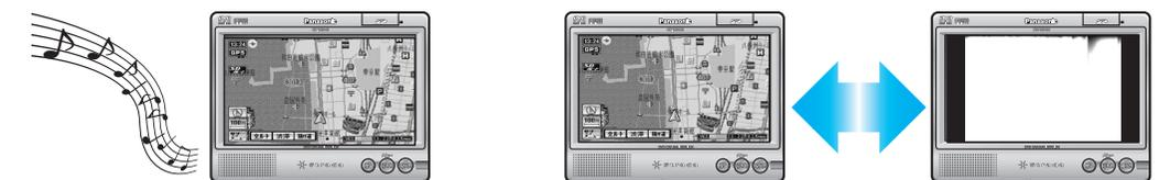
リモコンの操作切り替えスイッチを「AV」側にすると、ナビ画面を表示させたまま、リモコンでDVDなどを操作できます。ナビゲーションを操作するときは、「NAVI」側に戻してください。
