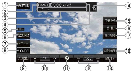
⑥ SOUNDメニューを表示して、[音の匠/DSP] / [バランス/フェーダー] / [BASS/TREB] を設定します。[図] P.107、P.108
