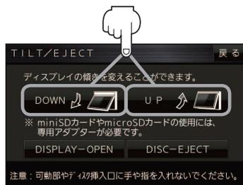
**お知らせ** エンジン切る (ACC を OFF にする) と、モニターは自動で閉じ収納されますが、次回、エンジンをかける (ACC を ON にする) と、前回調整した角度でモニターが開きます。
