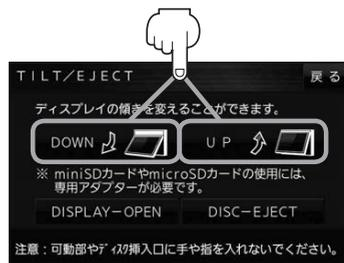
**お知らせ** エンジンを切る(ACCをOFFにする)と、ディスプレイは自動で閉じ収納されますが、次回、エンジンをかける(ACCをONにする)と、前回調整した角度でディスプレイが開きます。
