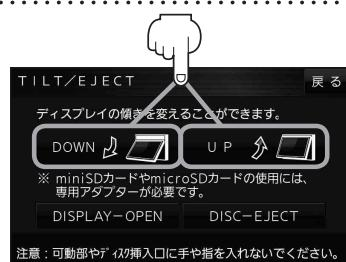
**お知らせ** エンジンを切る(ACCをOFFにする)と、ディスプレイは自動で閉じ収納されますが、次回、エンジンをかける(ACCをONにする)と、前回調整した角度でディスプレイが開きます。
