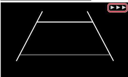
カメラ映像を表示中に、3Dセンサーが車両の旋回を感じると、旋回方向を矢印で表示します。
