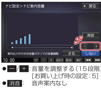
本体の音量ボタンでナビゲーションの音量を調整する／しないを設定する
