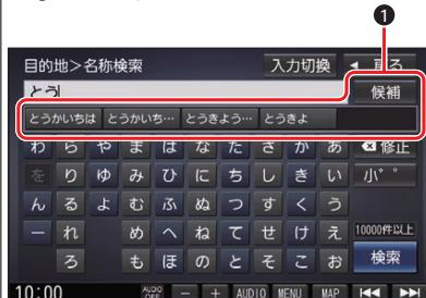
① 入力した履歴から、候補が5件まで表示されます。表示された候補から選ぶか、候補を選んでリストから候補を選ぶと、その名称が入力欄に表示されます。
