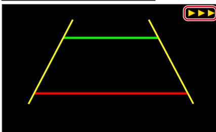
カメラ映像を表示中に、3Dセンサーが車両の旋回を感知すると、旋回方向を矢印で表示します。
