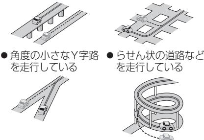
そのまましばらく走行すると、マップマッチングやGPS衛星からの情報を利用して自車マーク位置は自動的に補正されます。
