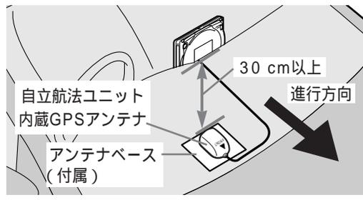
**3** GPSアンテナの取付角度を確認する(☞42ページ)
