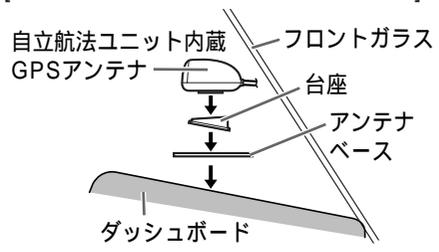
**4** 自立航法ユニット内蔵GPSアンテナを固定する
