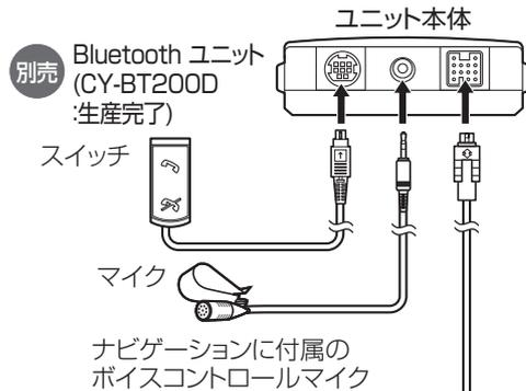
ナビゲーションに付属のボイスコントロールマイク (音声認識用) は、取り外さないでください。
