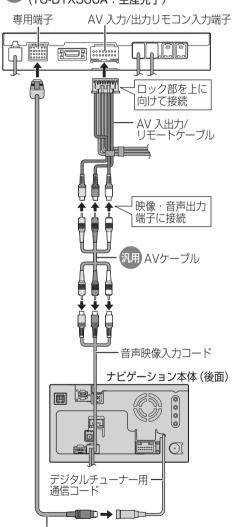
車載デジタルチューナー・ナビリモコン 専用ケーブル(CA-LDTR60D: 生産完了)
