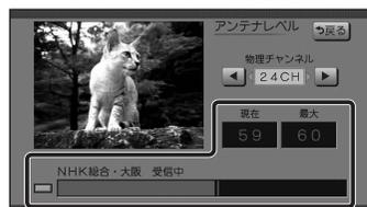
● アンテナレベルは受信状況を確認するための目安です。表示される数値は、受信している電波の強さではなく、質(信号と雑音の比率)を表します。
