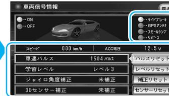
次の場合にも、「車速パルス」「学習レベル」「ジャイロ角度補正」「3Dセンサー補正」をリセットしてください。
