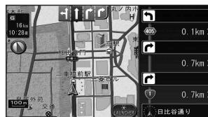
ルート案内中に自車から3つ先までの分岐点(交差点、IC、経由地など)が表示されます。分岐点の名称、進む方向、区間距離、路線番号が表示されます。
