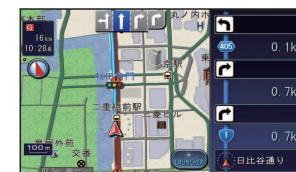
ルート案内中に自車から3つ先までの分岐点(交差点、IC、経由地など)が表示されます。分岐点の名称、進む方向、区間距離、路線番号が表示されます。
