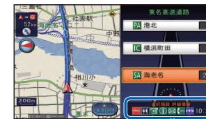
ルート案内中に都市高速、都市間高速道路、一部の有料道路を走行すると自動的に表示されます。SA・PA・IC・JCTの名称、自車からの距離、SA・PAの施設がわかりやすく表示されます。
