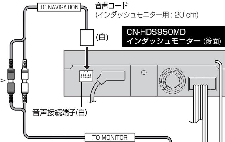
● 音声コード(ナビゲーション本体用: コネクター 黒)と、音声コード(インダッシュモニター用: コネクター 白)を正しく接続してください。逆に接続すると、プリアウト出力されません。また、音声認識が正しく動作しません。
