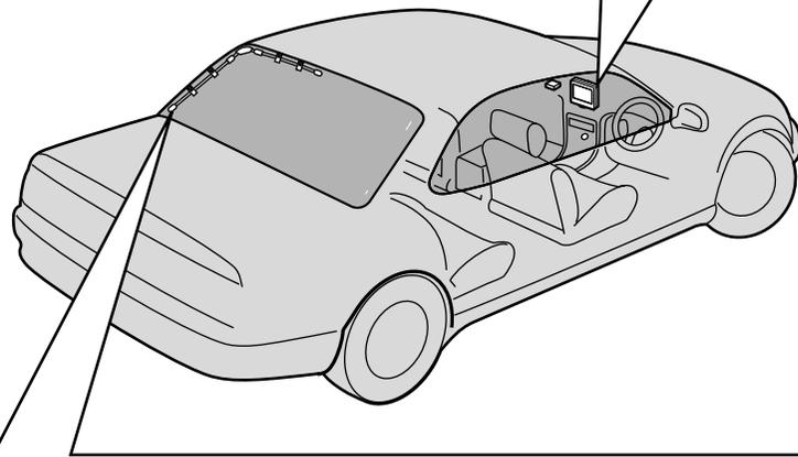
リアウィンドウ室内側に取り付けます。フロントガラスには取り付けないでください。上下逆に取り付けないでください。
