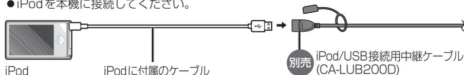
必ず別売のiPod/USB接続用中継ケーブル(CA-LUB200D)で接続してください。他のナビゲーションに付属されているケーブルを使用すると、正しく動作しない場合があります。
