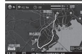
曜日時間規制探索やDRGSで新しいルートが再探索されたとき、変更前のルートも通行できる場合は、変更後のルートと変更前のルートを約8秒間表示します。(新旧ルート比較) 表示が消えるまで何も操作しないと、変更後のルートで案内を開始します。
