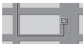
目的地が中央分離帯のある道路に隣接している場合、施設の前に到着するように(施設が自車の左側になるように)ルートを探します。
