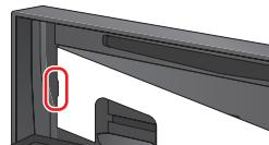
●パネル裏面の突起を、本体の孔に込み合わせてください。
