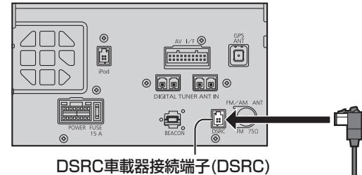
DSRC車載器接続端子(DSRC)
