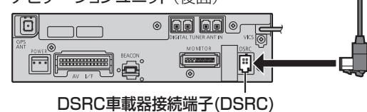
DSRC車載器接続端子(DSRC)
