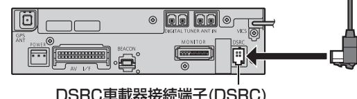
DSRC車載器接続端子(DSRC)
