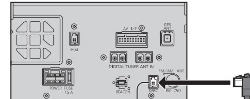
DSRC車載器接続端子(DSRC)
