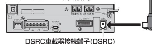
DSRC車載器接続端子(DSRC)
