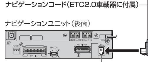
ETC2.0車載器接続端子(DSRC)
