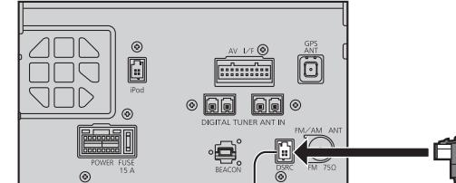
ETC2.0車載器接続端子(DSRC)
